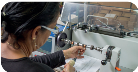
Bobinage des transformateurs
